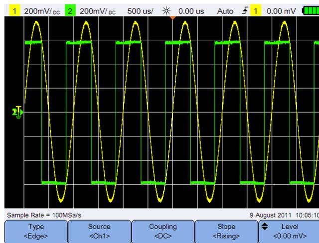
**Figura 3-5** Sottomenu di Trigger type and settings
